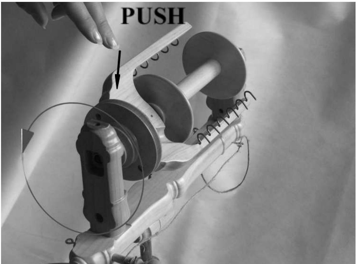
Bitte prüfen ob, nach mit der Hand einleiten Flügel in Drehbarbewegung, Flügel drehen sich leicht, ohne bremsen.
